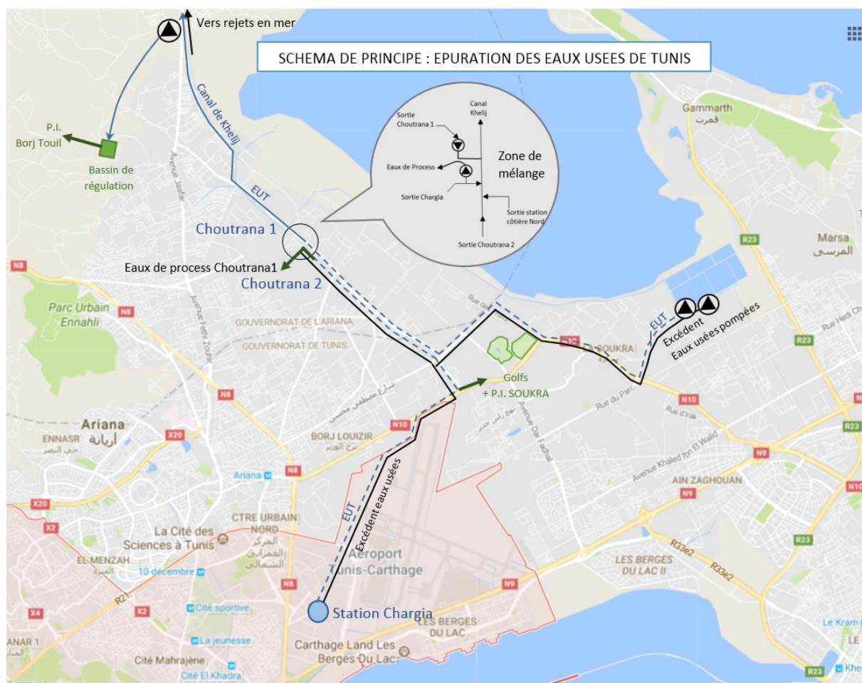
Figure 7 : Principe de fonctionnement du système d'assainissement de Tunis Nord
