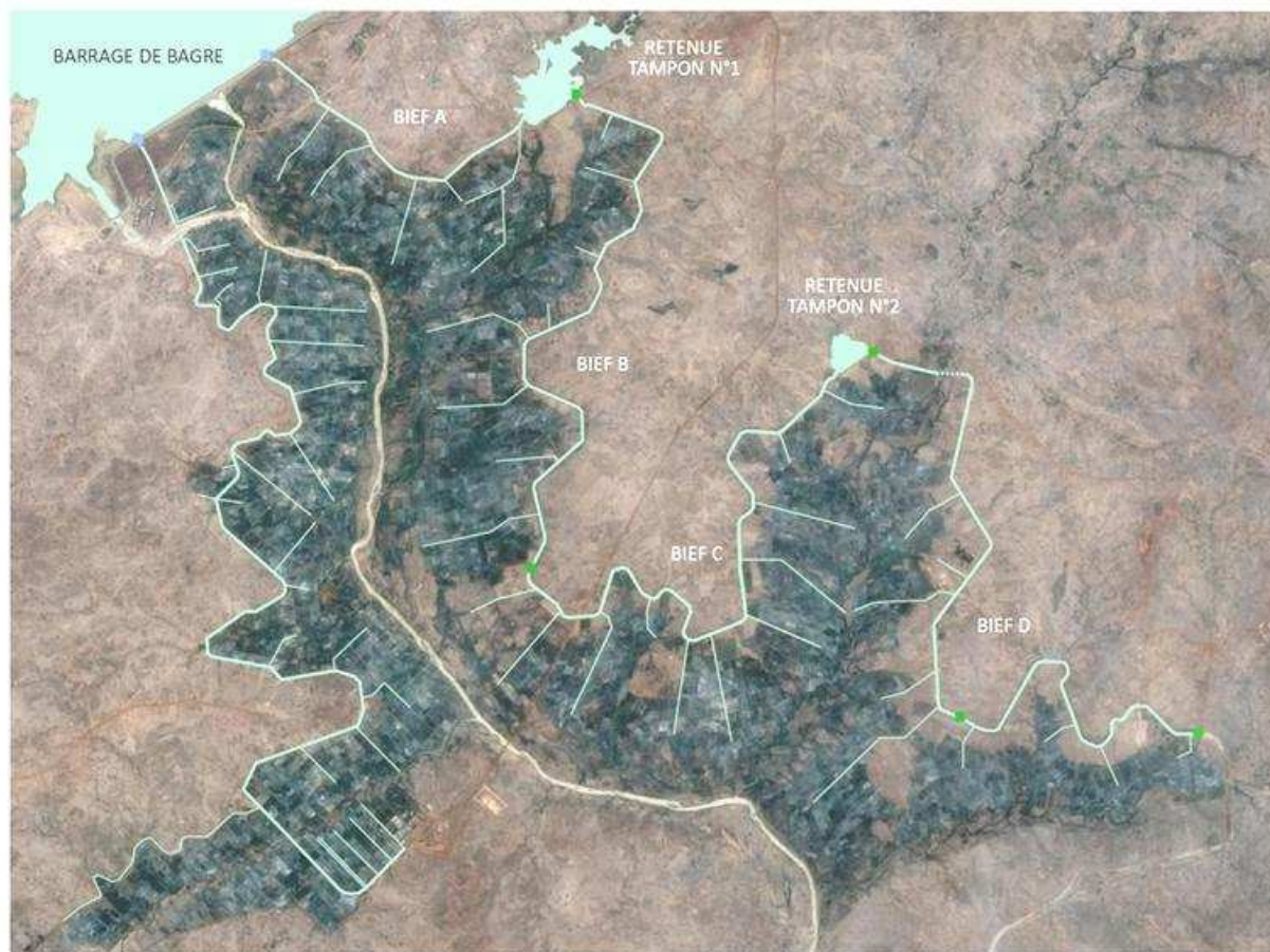
Figure 3 : Plan d'ensemble des ouvrages primaires et secondaires
