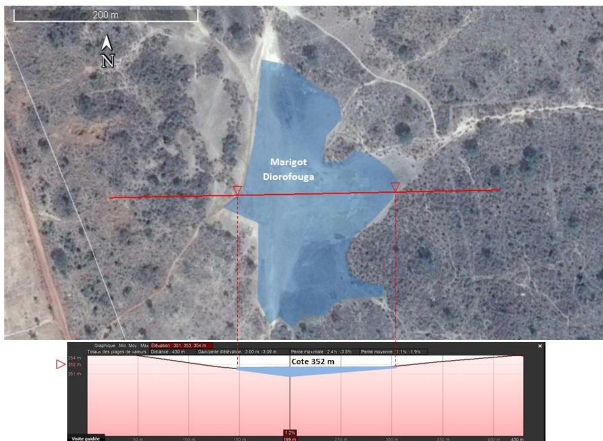
Figure 26 : Vue en plan et coupe en travers du marigot de Diorofouga.
