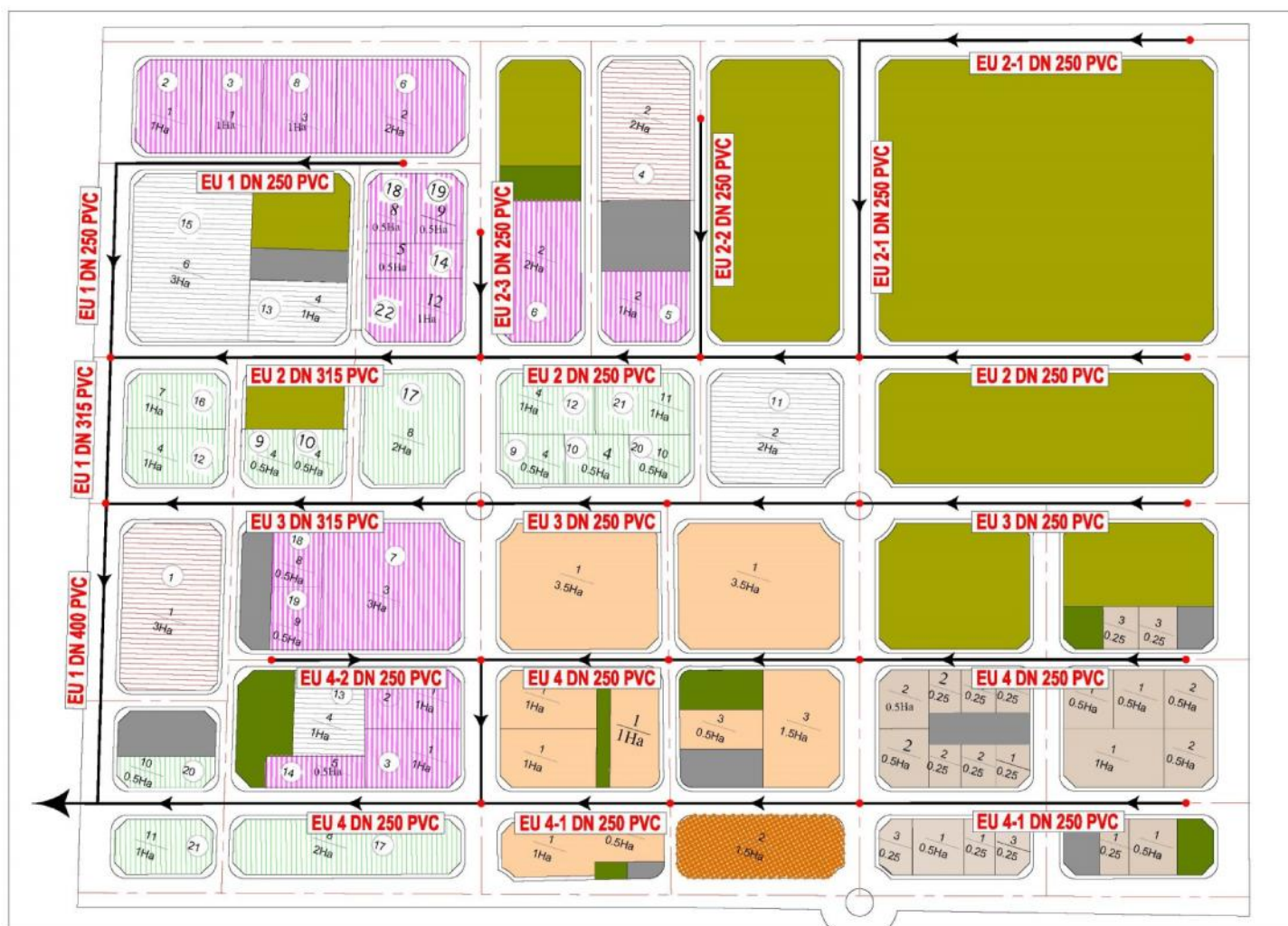
Figure 15 : Tracé du réseau eaux usées projeté
