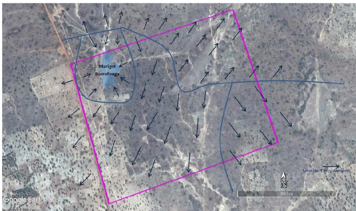
Figure 25 : Sens d'écoulement des eaux de ruissellement
