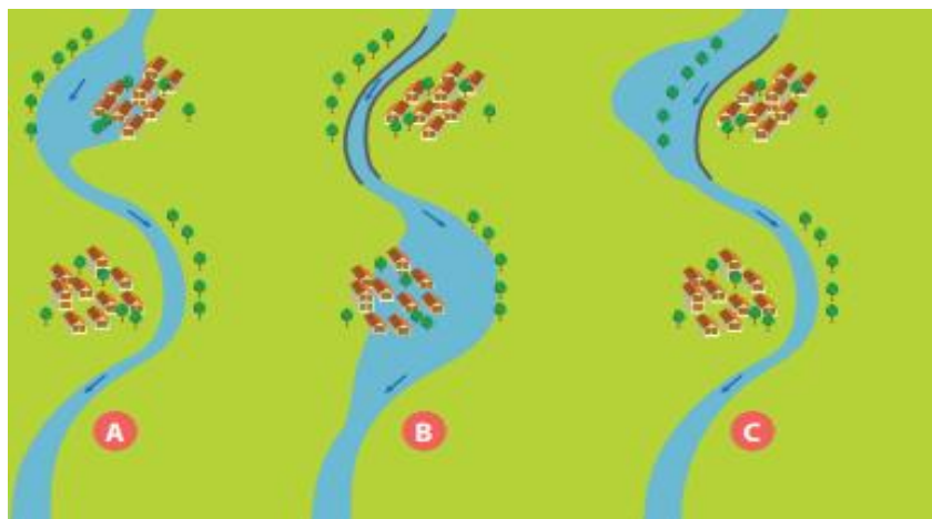
Figure 17 : Etat avant et après la réservation de zones d'expansion de crue
