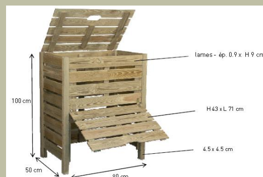
Figure 28. Dimensions d'un bac de compostage
