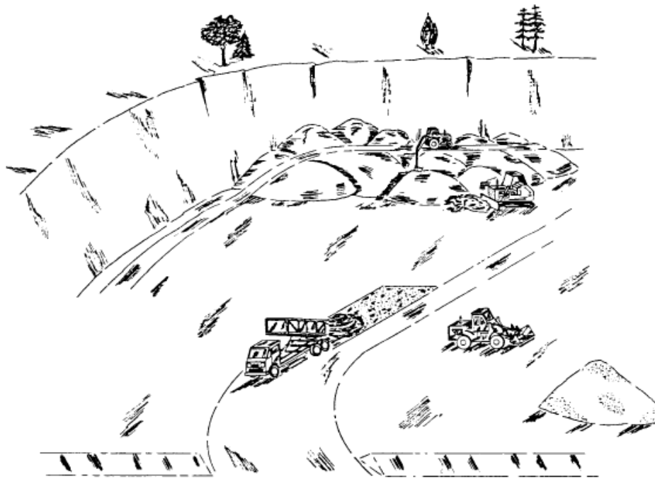
Figure 6. Exploitation de zones de Confinement par tas
