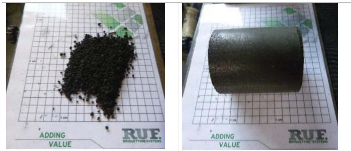
Figure 24: Boues de STEP (siccité 93%) avant et après l'opération de briquetage (photos RUF briquetting Systems)
