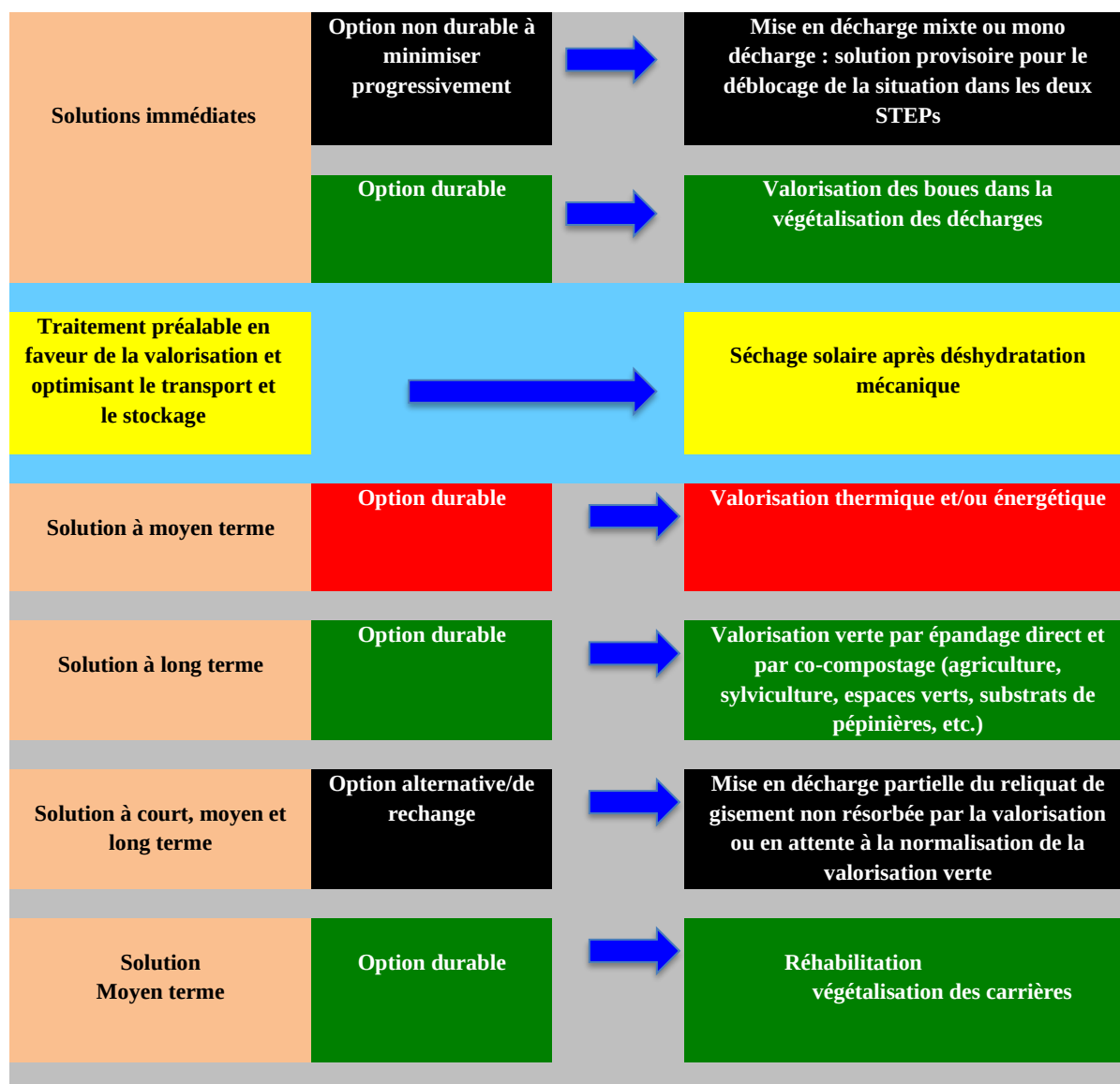
Figure 11. Options envisageables pour l'élimination et la valorisation des boues des STEPs d'Al Hoceima et de Nador
