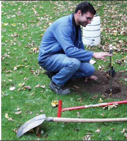
Prise de mesure de la vitesse d'infiltration par la méthode à niveau variable. (Photo Epuvaleur asbl)
