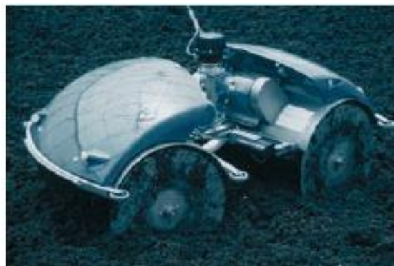
FIGURE 42 : ENGIN D'ETALAGE ET DE TRAVAIL SUPERFICIEL DES BOUES (SANGIER ELECTRIQUE) (D'APRES LE FABRICANT (1))
