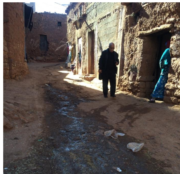
Photo 1 : Exemple de point de rejet direct des eaux usées brutes (village Talatast, Commune rurale de Tighedouine, 2018)
