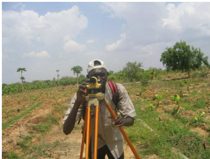
Figure 6 : Une lecture sur la mire, au cours du nivellement
