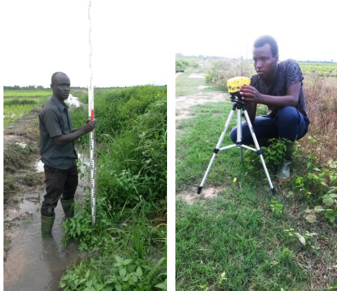
Figure 12: Mesure de côte de fond dans le drain tertiaire du CT2D au CSB5
