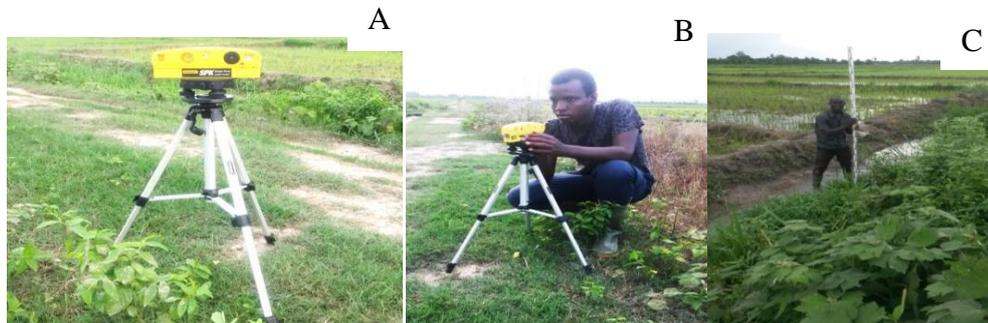
**Figure 17:** Dispositif mis en place pour la mesure des dimensions du drain tertiaire du CTD2 CSB5
